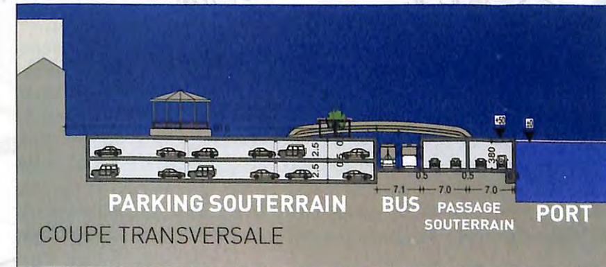
PARKING ET PASSAGE SOUTERRAINS
