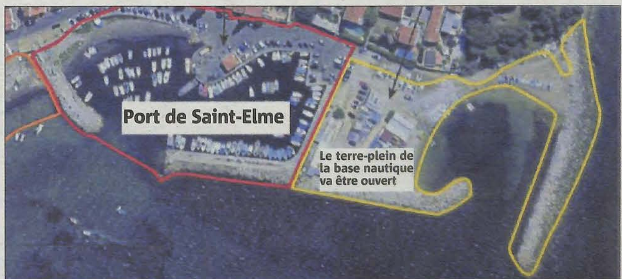
L'ouverture du terre-plein sur lequel est installée la base nautique va permettre de recréer un courant qui chassera tout ou partie des posidonies qui s'entassent dans le port. (doc TPM)
