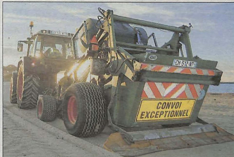
La cribreuse-tamiseuse ratisse le sable jusqu'à 30 centimètres de profondeur. Cette machine assure la collecte des déchets tout en préservant l'environnement.
