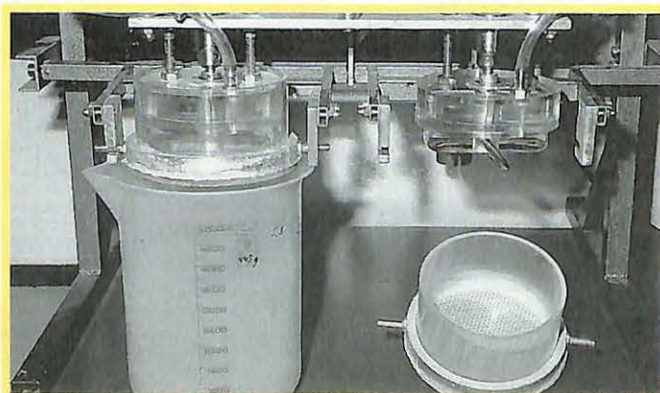
3a Figure 3. Détails du nouveau décanteur centrifuge miniaturisé pour la séparation amidon-gluten (d'après l'Université Technique de Berlin). 3a. Corps de l'appareil et vis. 3b. Système permettant l'extraction de l'amidon B. 3b
